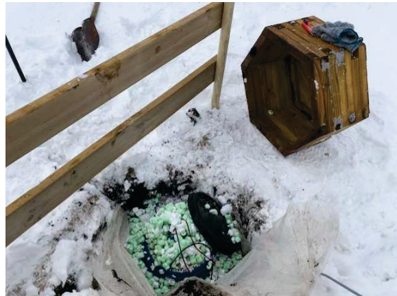
Mynd 20. Vatn komst inn í tunnuna sem geymir skynjarann sem varð til þess að skynjarinn flaut upp og einnig frauðplastið sem var í tunnunni. Þrýstingurinn varð til þess að lokið fór af tunnunni. Það sást þegar blómapotturinn var tekinn af.
