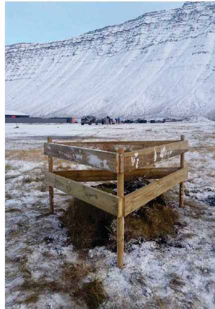
Mynd 4. Innhljóðsnemi grafinn í tunnu, með blómapotti yfir og fyllt upp að með jarðvegi. Girðingin var sett upp til þess að auka sýnileika
